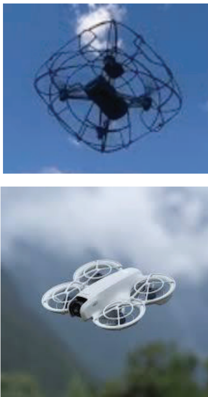
Fig. 2. Mini drones equipped with protective cage
